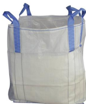
Obrázek 10 Velkoobjemový vak (tzv. big bag) simulující zatížení chodci
