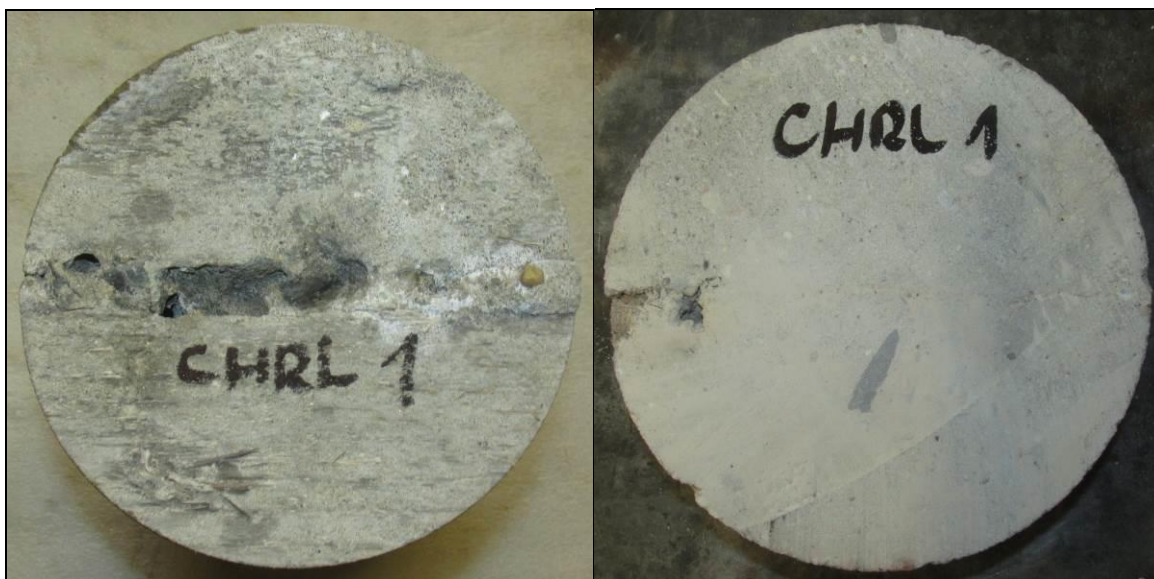
Foto 3: Celkový pohled na čelo vývrtnu CHRL1 před zkouškou (před a po zarovnání původního čela vývrtnu)
