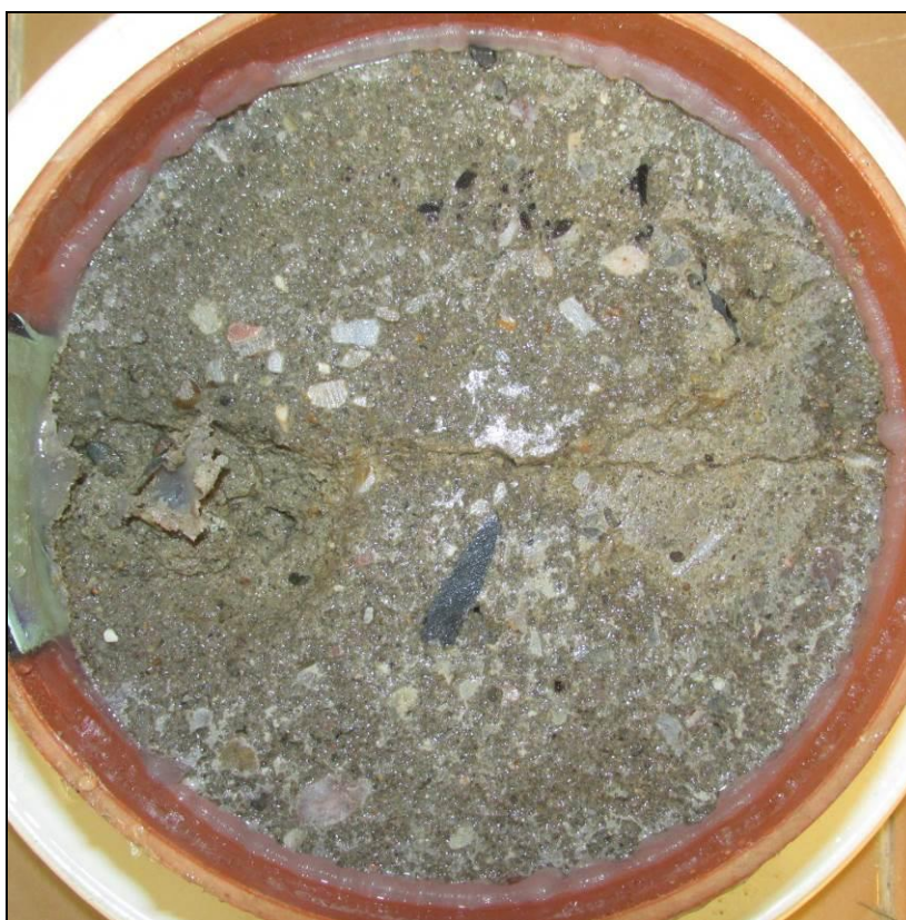
Foto 4: Pohled na čelo vzorku CHRL1 – po CH.R.L. - metoda C – 25 cyklů
