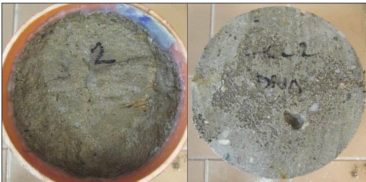
Foto 6: Pohled na čelo a dno vzorku CHRL2 – po CH.R.L. - metoda C – 75 cyklů
