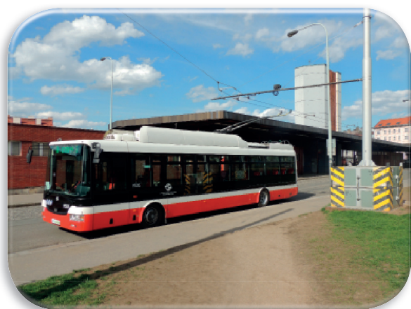
Trolejbus SOR TNB 12 při dobíjení na Palmovce
